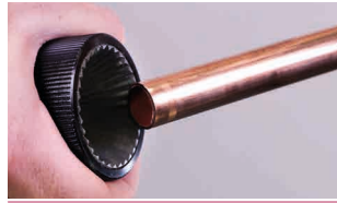
2. Rohr innen und außen entgraten
