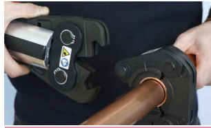
9b. Die Zwischenbacke ansetzen
