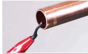
3. Rohr innen und außen entgraten
