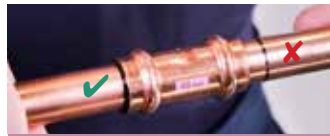
8. Insérez le tuyau dans le raccord. Le tuyau doit être complètement inséré avant d'effectuer le sertissage
