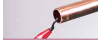
3. Utilisez un crayon ébavureur sur les bords intérieurs
