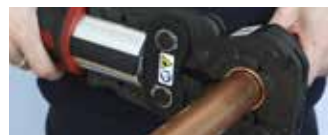
3. Effectuez le raccordement à l'aide de l'outil de sertissage
