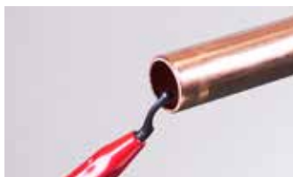
3. Utilisez un crayon ébavureur sur les bords intérieurs
