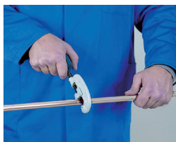
1. Corte de tubo 1. Cortar o tubo
