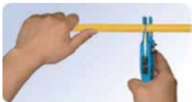
1.- Corte de tubo 1.- Cortar o tubo
