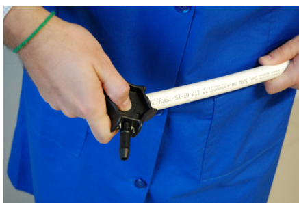
2. Abocardar y redondear el tubo 2. Abocardar e Arredondar o tubo
