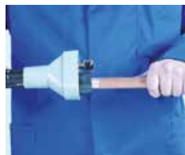
Limpieza exterior del tubo
