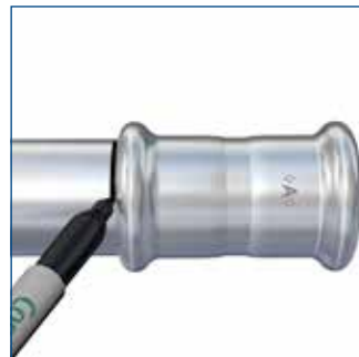
6. Assemblez et marquez la profondeur d'insertion
