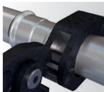
6. Engagement de l'actionneur et vérification de la profondeur d'insertion
