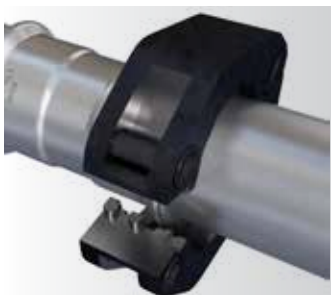
5. Fixation de l'anneau de sertissage
