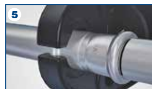
5 Completare la giunzione con gli strumenti di pressatura
