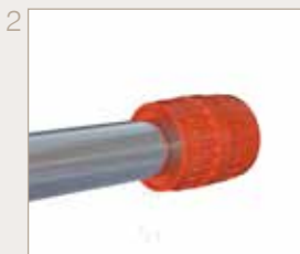
Sbavare il tubo esternamente ed internamente, eliminando le bave
