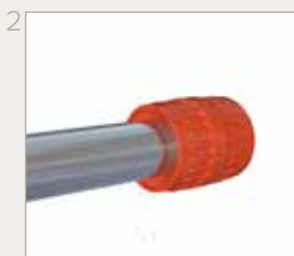
Sbavare il tubo esternamente ed internamente, eliminando le bave taglienti.
