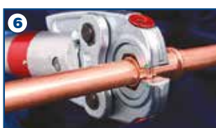
6 Allineamento delle ganasce al raccordo
