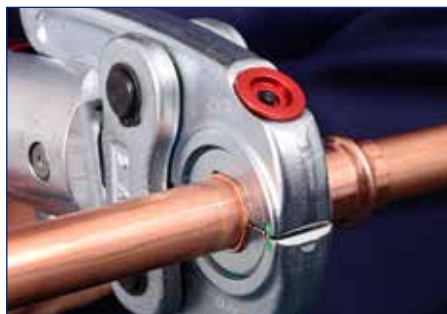
5. Completare la giunzione con gli strumenti di pressatura
