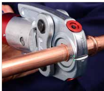
5. Completare la giunzione con gli strumenti di pressatura
