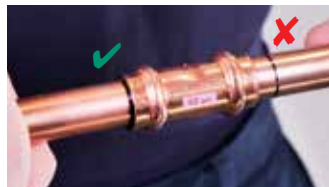
8. Inserire il tubo nel raccordo, assicurandosi che sia completamente in battuta prima di procedere alla pressatura
