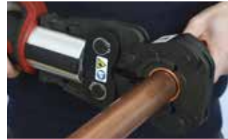
3. Completare la giunzione utilizzando utensili omologati
