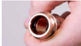
6. Verificare la presenza dell'O-ring di tenuta
