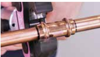
1. Allineare la ganasce perpendicolarmente al raccordo
