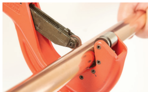
1. Vágjuk le a csövet a megfelelő hosszúságra
