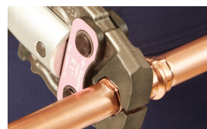
10. A préselést csak jóváhagyott szerszámmal végezze. Csak egyszer nyomja meg a gombot.
